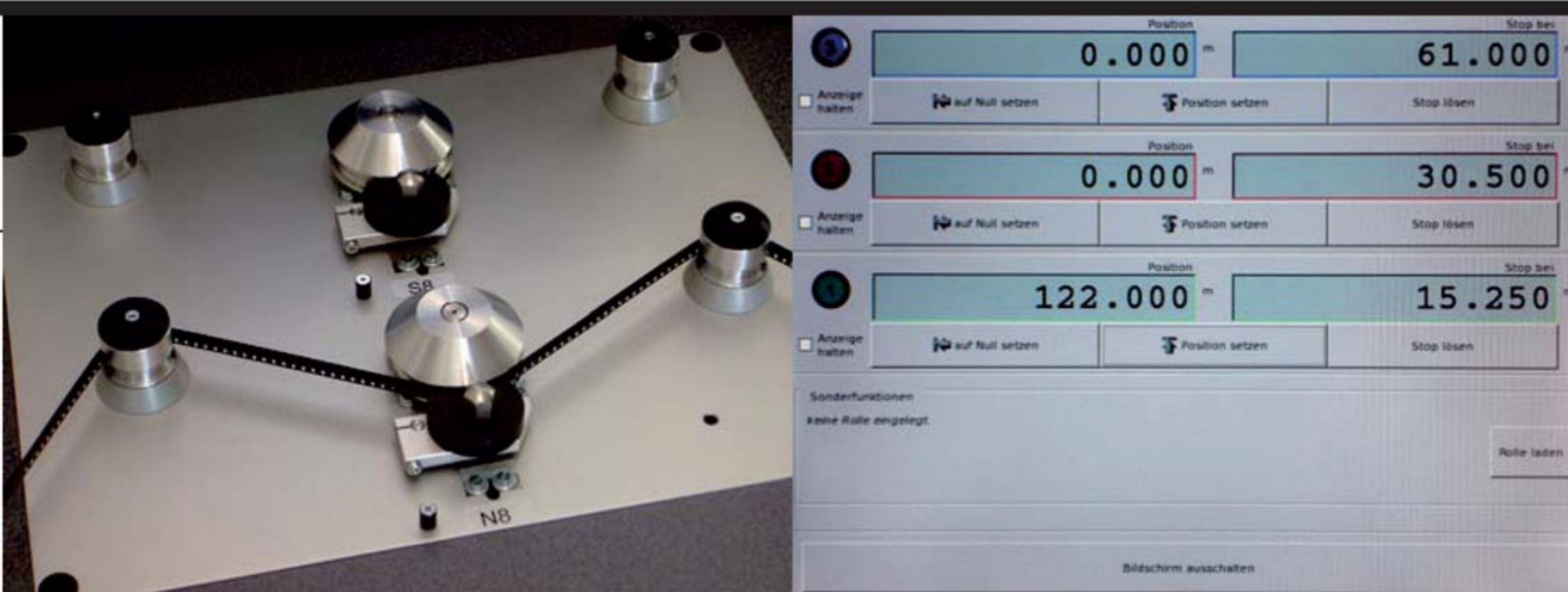
Umrolleinsatz für die Formate 8 mm und Super 8. Dieser Einsatz kann auch auf 16 mm und 35 mm gewechselt werden.
